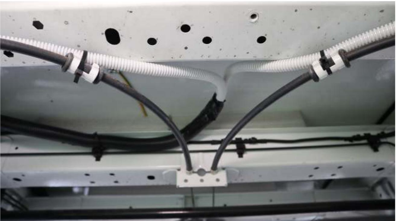
**Die beiden Leitungen wurden an den Handbremsseilen befestigt und in ein dickeres schwarzes Wellrohr geführt, das links am Unterboden nach vorne zum Batteriekasten (Plastikwanne) vor dem Fahrersitz führt. Geht man hier nach innen, kann man die Leitungen zusammen mit anderen Kabeln weiter führen.**
