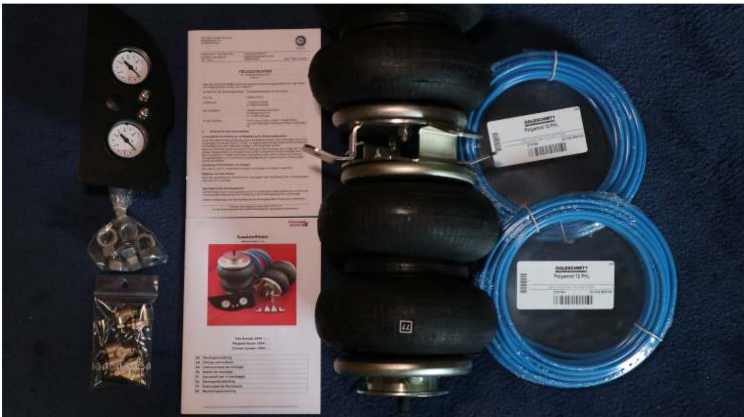
**Zur Vorbereitung des Einbaus wurden die Bälge mit dem Anschlusswinkel und einem kurzem Schlauchstück versehen**
