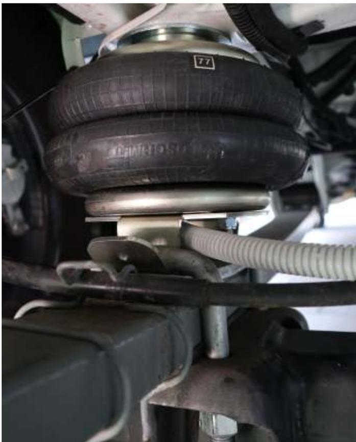
**Statt der Puffer wird dann der Luftfederbalg oben eingeschraubt und unten mit den vorhandenen Brieden festgeschraubt (vorgeschrieben sind 130Nm) Die Druckluftleitungen (hier schon mit Schutzrohr versehen) wurden mit Cuttermesser gerade abgeschnitten und konnten mit etwas Kraft in die Anschlüsse gedrückt werden. Man kann sie auch mit Druck auf den Ring wieder lösen.**
