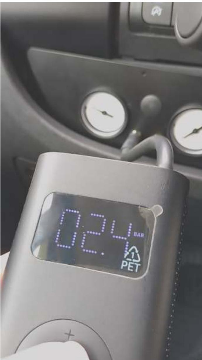
**Zum Aufpumpen dient eine Akkuluftpumpe von Xiaomi, die mal für Bikes angeschafft wurde. Der Minikompressor kann 10 Bar, hat nur die Größe einer Getränkedose und eine programmierbare Abschaltung. Funktioniert gut !**
